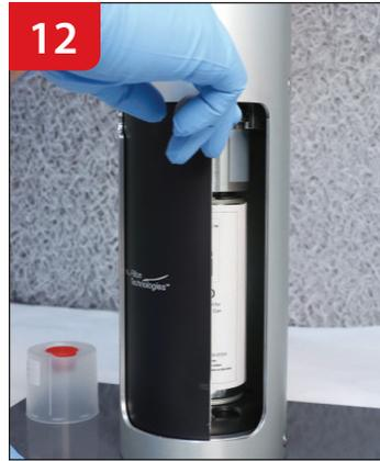
**12** Ouvrez le volet. Faites tourner le plateau de l'appareil dans le sens des aiguilles d'une montre. Retirez le contenant.
