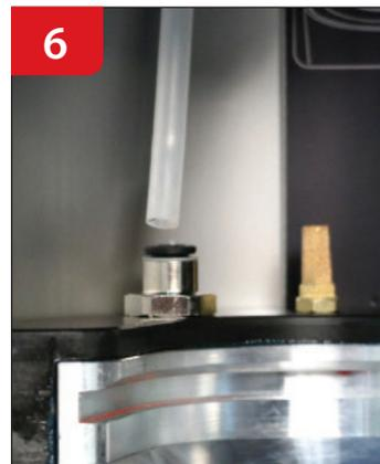
Fixez la conduite au raccord à l'intérieur de l'appareil.
