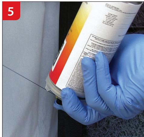
5 Retirez le godet supérieur en plastique avec indicateur de couleur. En le détournant de vous, renversez le contenant et purgez-le jusqu'à l'obtention d'un jet de forme régulière.
