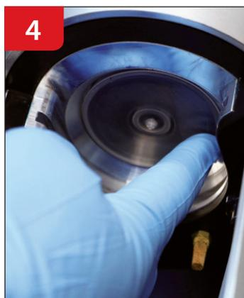
Ajustez les bords du disque de remplissage et appuyez fermement pour vous assurer qu'il est bien en place.
