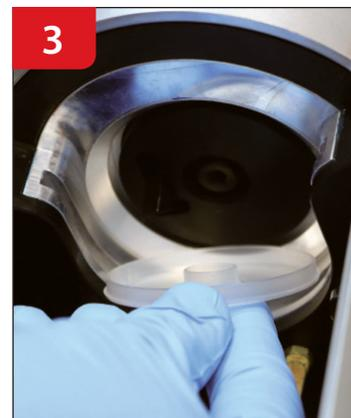
Placez le disque de remplissage sur le tampon d'appui à l'intérieur de l'appareil.
