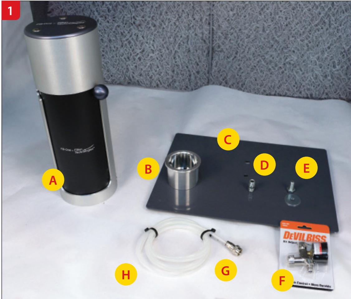
Assurez-vous d'avoir l'équipement suivant : appareil de remplissage (A), godet cylindrique en métal (B), socle (C), double raccord mâle (D), boulon court (et non long) et rondelle (E), manomètre à air comprimé (F), raccord rapide (G), conduite d'air (H).
