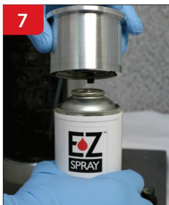
Insérez le godet cylindrique en métal dans la tête de remplissage du contenant. Insérez le godet en plastique dans le godet en métal.
