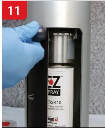
**11** Fermez le volet de l'appareil pour lancer le remplissage (environ 3 à 6 secondes).
