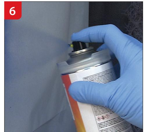
6 Redressez le contenant et faites un essai de pulvérisation avant d'appliquer le produit.
