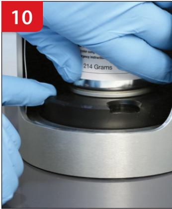
**10** Faites tourner le plateau de l'appareil dans le sens antihoraire jusqu'à ce que le contenant aérosol soit fermement fixé.
