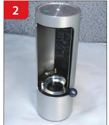
Placez l'appareil de remplissage à l'envers.
