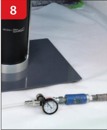
Raccordez la conduite d'air au manomètre et à l'alimentation en air comme ci-dessus.
