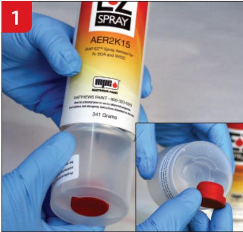
1 Retirez le bouchon inférieur avec piston rouge. Retirez le piston rouge du bouchon inférieur.
