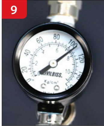
Réglez le manomètre à air comprimé à 110 lb/po<sup>2</sup>.
