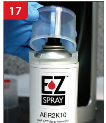
**17** Placez le godet de remplissage en plastique, où la couleur est visible, sur le contenant aérosol.
