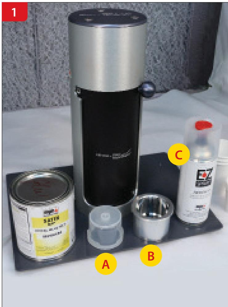
Assurez-vous d'avoir l'équipement suivant : godet de remplissage en plastique, anneau adaptateur, disque de remplissage (A), godet cylindrique en métal (B), bouchon avec piston rouge (C).
